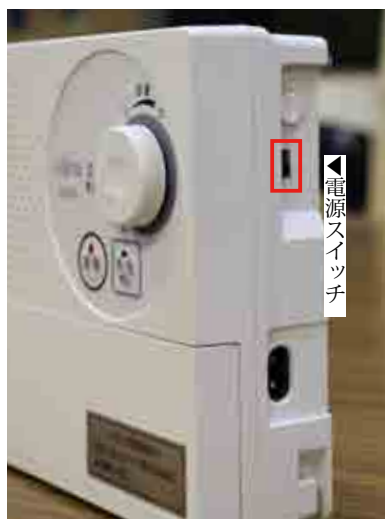
▲受信機右側の電源部分
