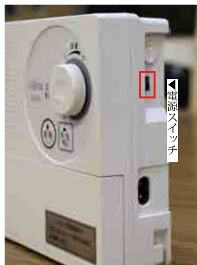
▲受信機右側の電源部分
