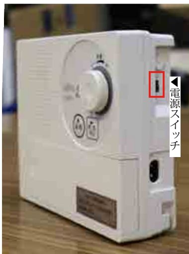
▲受信機右側の電源部分
