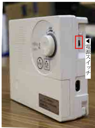
▲受信機右側の電源部分
