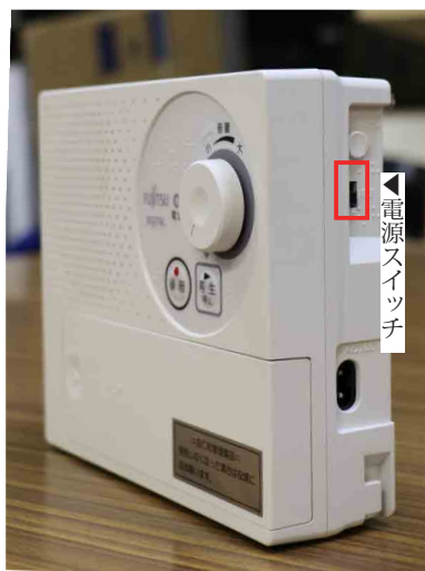
▲受信機右側の電源部分
