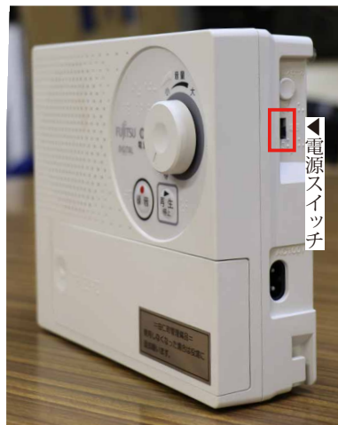
▲受信機右側の電源部分
