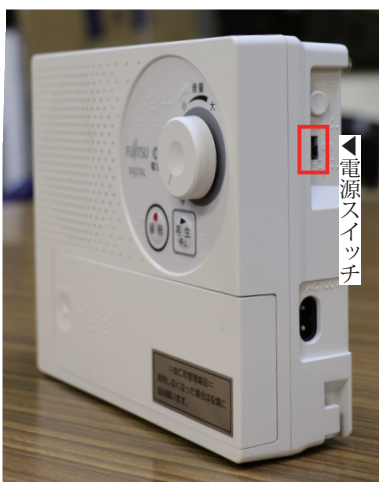
▲受信機右側の電源部分
